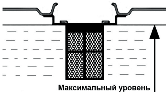
Максимальный уровень топлива в топливном баке
